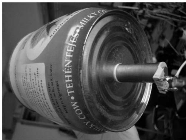
10. ábra. A mikrofon konzervdobozból.
