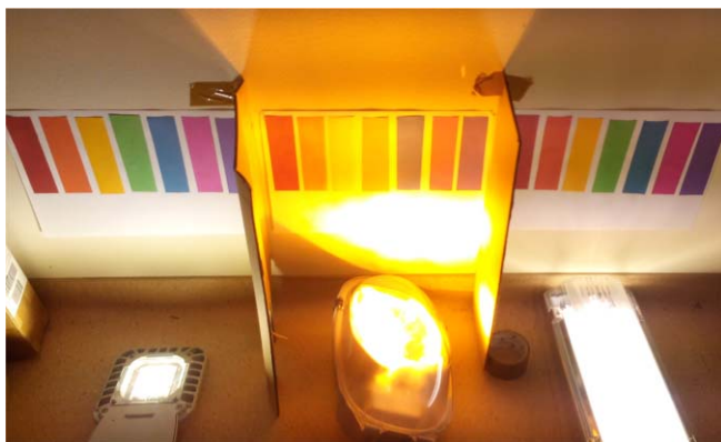
3. ábra. Színvisszaadás-mérés: LED, Na-lámpa, kompakt fénycső.
