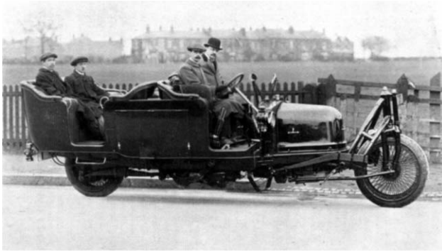
13. ábra. Schilowsky pörgettyűvel stabilizált járműve (1914).
