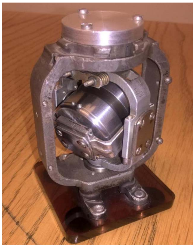
20. ábra. 9M14 Maljotka távirányítású páncéltörő rakéta pörgettyűje az 1980-as évekből.
