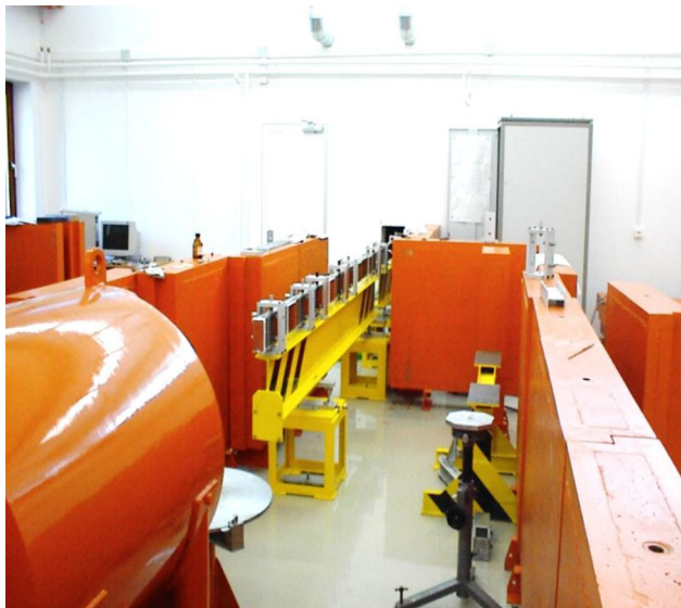
2. ábra. Középen a neutronvezető, mintaállvány (részben takarásban) és balra a nyalábcsapda.
