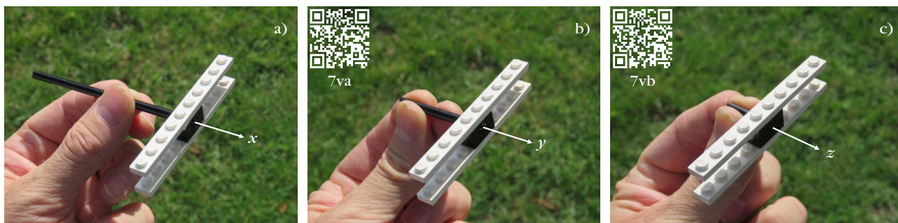
7. kép. Három különböző tárgy legóból. A fekete tengely az adott tárgy a) legkisebb, b) közbülső, c) legnagyobb fő tehetetlenségi nyomatóka. Lásd a 7va és 7vb videóklipet, amelyek megtekinthetők a QR-kódokra kattintva, illetve a 3. és 4. lábjegyzet segítségével.
