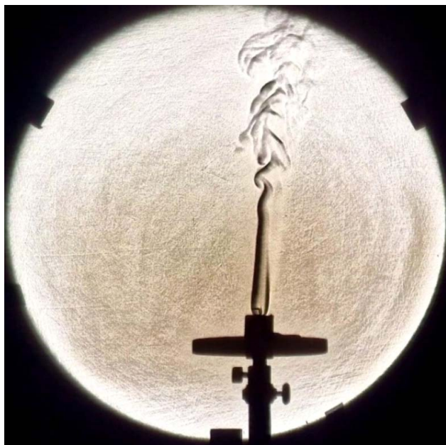
1. ábra. Gyertyaláng hője által keltett áramlás egy általunk készített Schlieren-felvételén.
