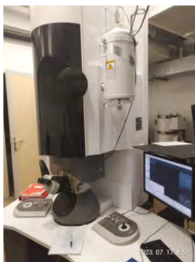
A gömbhiba-korrigált THEMIS 200 TEM/STEM mikroszkóp Angström alatti felbontással
