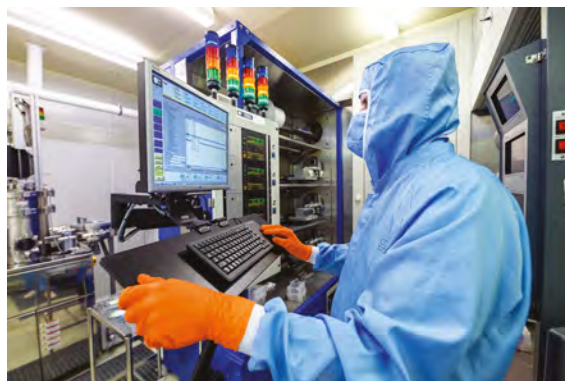
A Mikrotechnológia laboratóriumában telepített szilícium szeletek oxidálására és hőkezelésére alkalmas magas hőmérsékletű kályha
