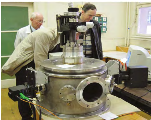
3. ábra. Ionimplantációs kamrára szerelt folyamatkövető ellipszométer
