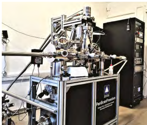
Az ultranagy vákuumban működő pásztázó alagútmikroszkóp
