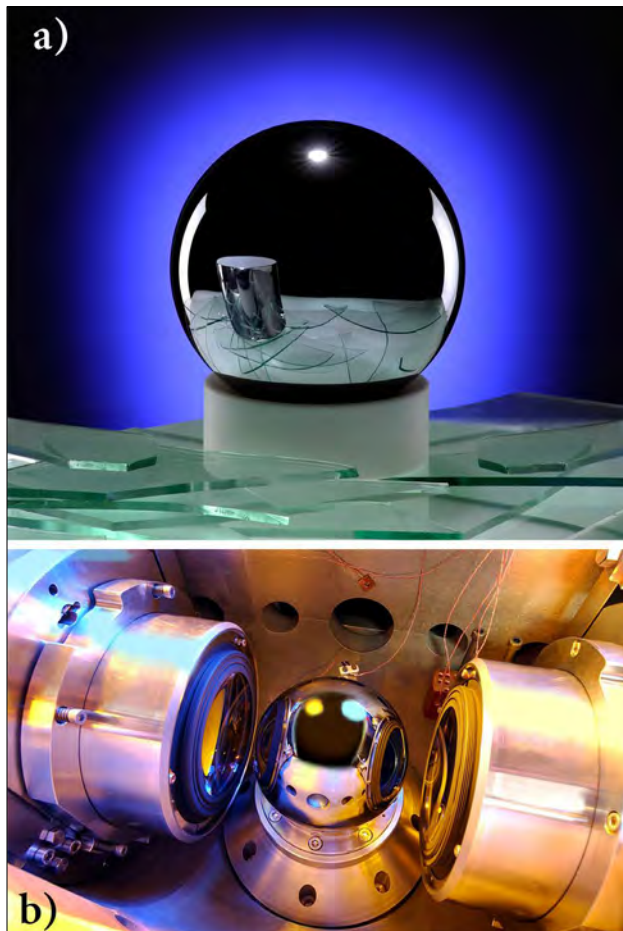
3. ábra. A gömb, amelyben megszámták az atomokat. (a) A Nemzetközi Avogadro Koordinációs Projekt számára készült szilícium egykristálygömbök egyike, melynek tömege a röntgenes kristálysűrűségmérés révén közvetlenül a Planck-állandóhoz köthető. (b) A projekt számára készült három gömbi interferométer egyike (kettő található Németországban és egy Japánban). A gömb átmérője a tárgy jelenlétében, illetve anélkül mért optikai úthosszak különbségéből határozható meg
