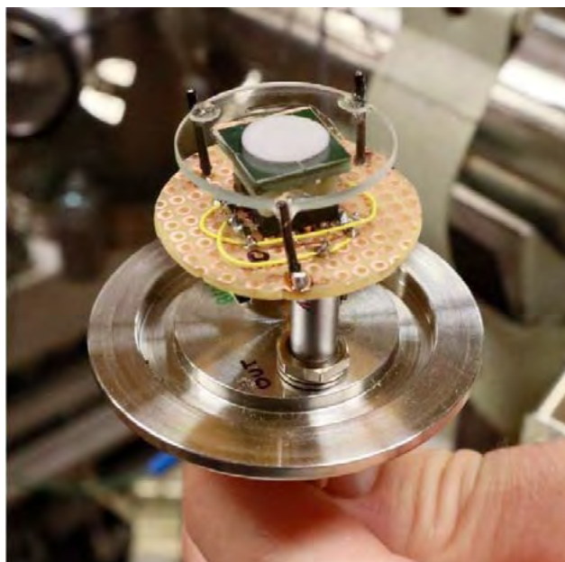
3. ábra. Perovszkit vékonyréteges fotoelektron-sokszorozóval egybeépített detektor prototípusa
