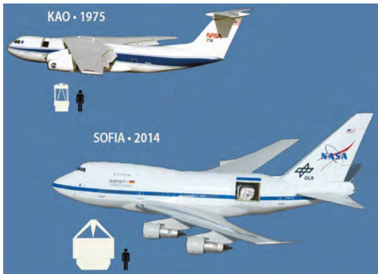
1. ábra. A NASA repülőgép fedélzetére helyezett KAO és a SOFIA infravörös obszervatóriumai. A fedélzeti távcső méretét a repülőgép alatti kis piktogram szemlélteti. (Forrás: NASA/SOFIA/L. Proudft – közkinccs)
