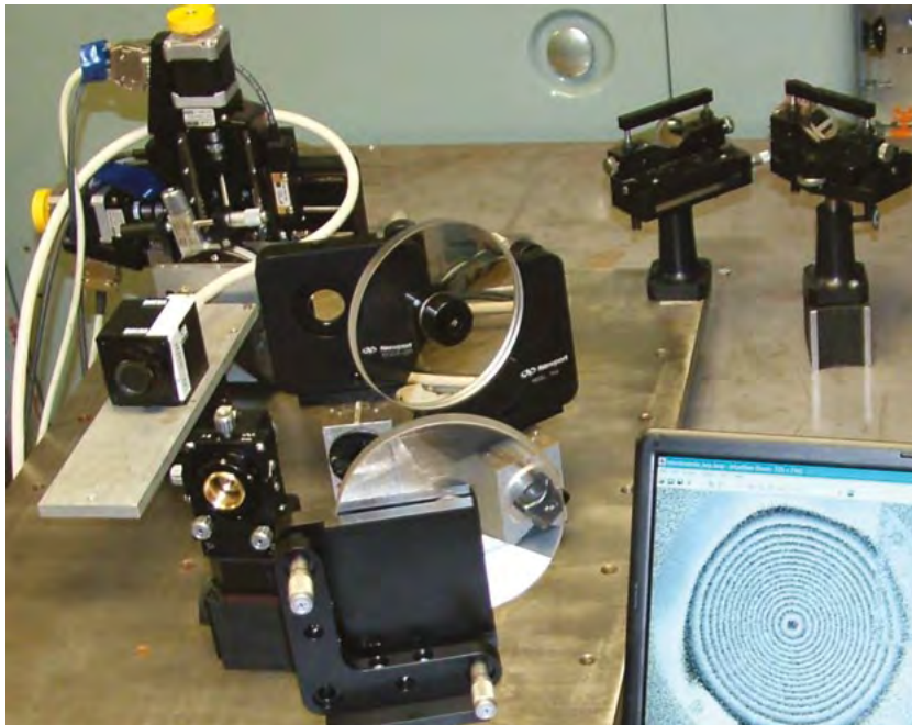
13. ábra. A BME-vel közösen létrehozott DIADDEM holografikus berendezés laboratóriumi változatának részegységei
