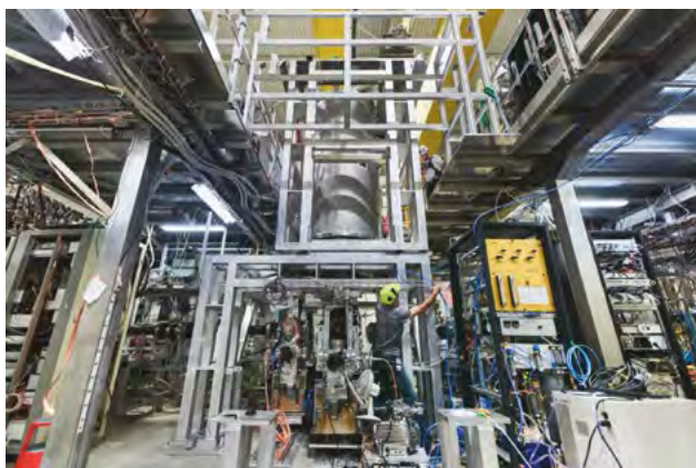
5. ábra. Az ALPHA kísérlet mérőberendezése a gravitációs mérés idején. Középen látható az antiproton-röptetés függőleges hengere
