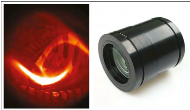
6. ábra. A W7-X plazmaképe (forrás: WIGNER RCP), és a 30 fokos látószögű objektív (forrás: OMI)
