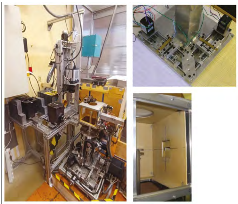
11. ábra. A NORMA mintatartó mechanikai rendszere a kameratoronnyal, a cserélhető optikai előtéttekkel és a neutronblendével
