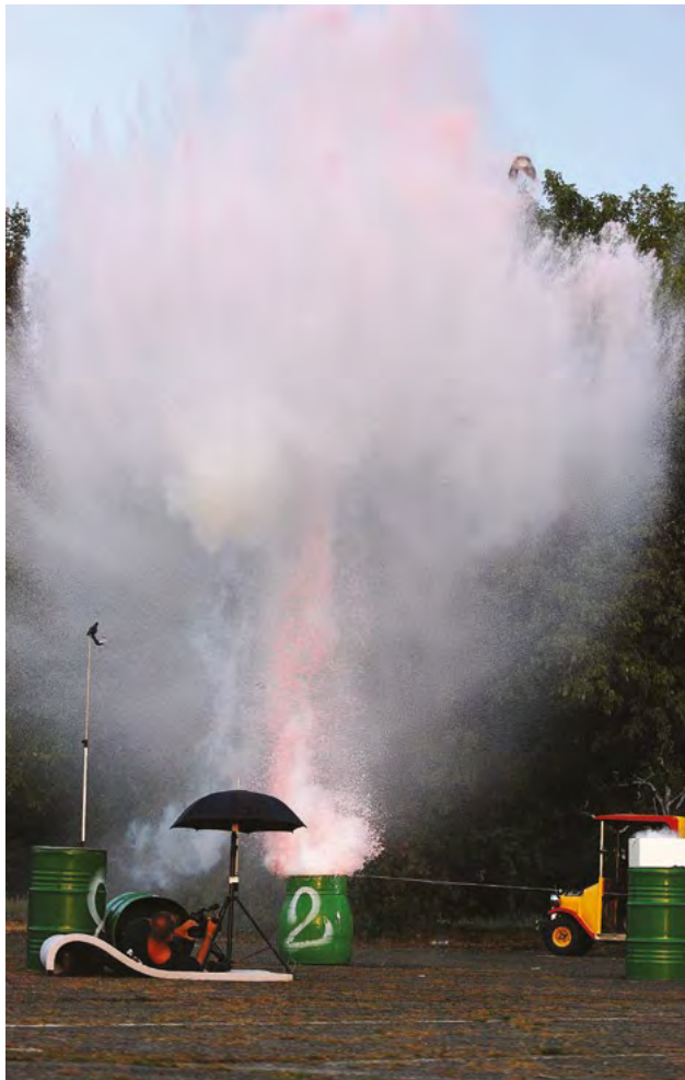
9. ábra. Hordó alakítása lökeshullámmal
