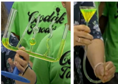
7. ábra. Szökőkút közlekedőedényekkel
