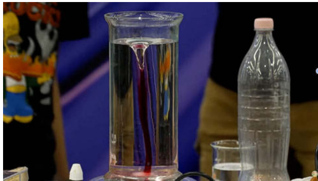
3. kép. Tornádómodell mágneses keverővel
