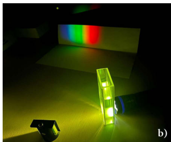
3. ábra. Az a) ábrán a zseblámpa látható tartománybeli színeke látható, a b) ábrán a flavin-mononukleotid (FMN) fényelnyelése a kék tartományban, vagyis a hiányzó szín
