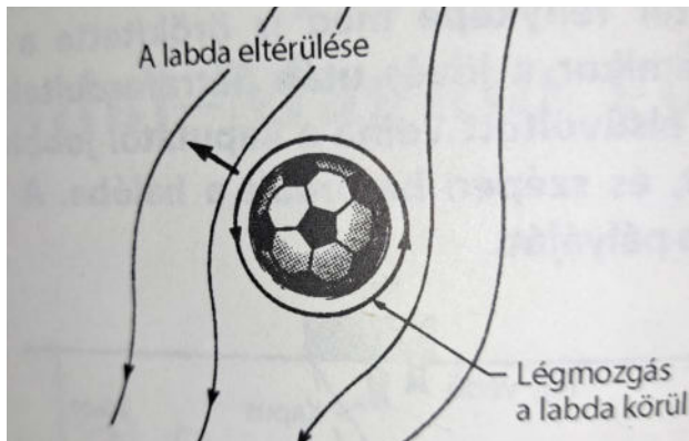
9. ábra. A labda két oldalán különböző a sebesség
