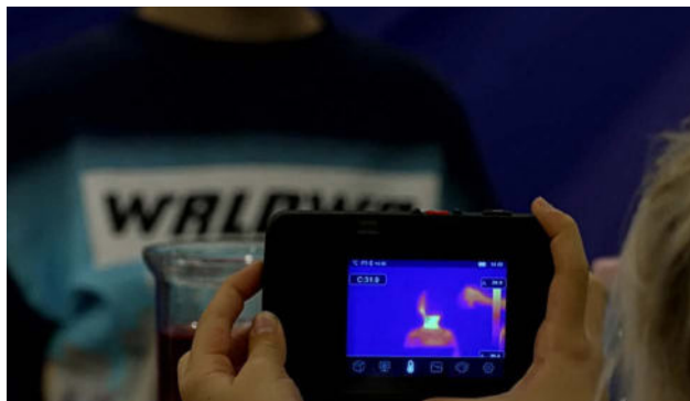
4. kép. Üveglap átérésztésének vizsgálata az infra tartományban
