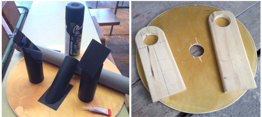
1. ábra. A Brewster-periszkóp alkotó elemei: PVC-cső, üveglapok, pillanatragasztó, festék (balra) és a deszkalapok (jobbra).
