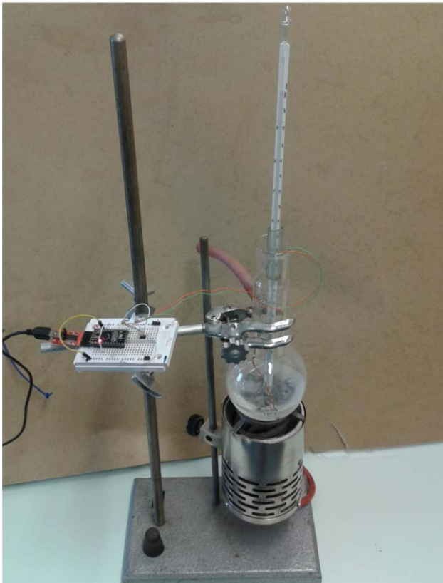
5. ábra. A termisztor kalibrálása hitelesített hőmérővel.
