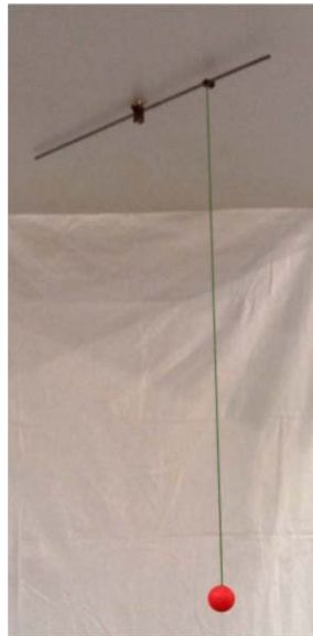
4. ábra. A késlekedő inga kísérleti összeállítása.
