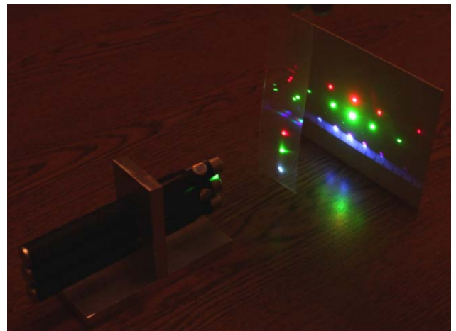
5. ábra. Az elhajlás hullámhosszfüggésének bemutatása lézermutatók segítségével.
