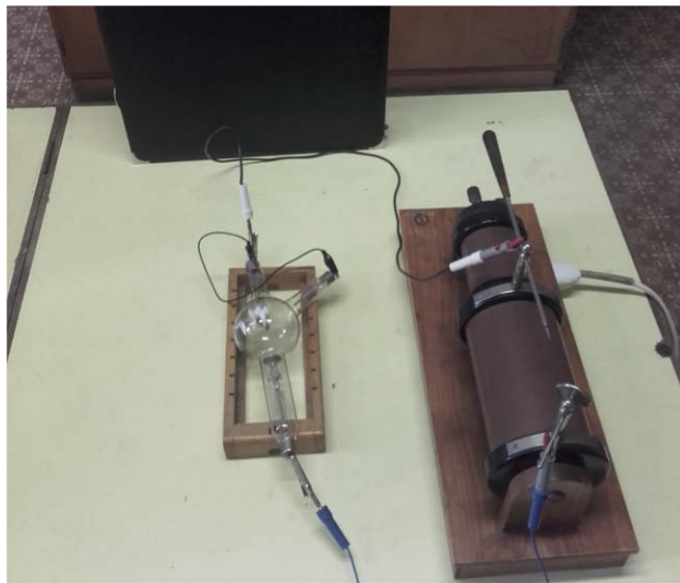
1. ábra. A kisülési cső a szikrainduktorral. Háttul, a fekete táskában ón-ólom lemezek találhatók, ez az „egyszemélyes” védőfal.
