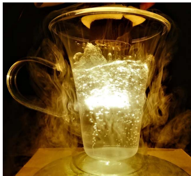
5. ábra. Villanykörte izzószála cseppfolyós nitrogénben.
