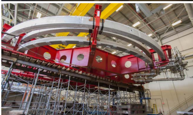
7. ábra. A müöngyűrű szállítása a New York melletti Brookhaven Nemzet Laboratóriumból a Chicago közelében levő Fermilabba vízen és közúton. Az utakon éjjel közlekedtek, és gyakran kellett leszerelni lámpaoszlopokat és útjelző táblákat.
