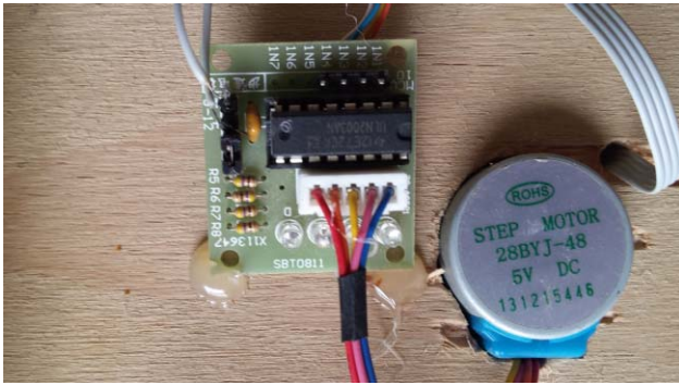
5. ábra. A szerelt léptetőmotor és vezérlő.
