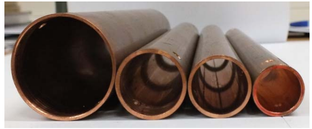
9. ábra. A méréshez használt 35, 22, 19 és 15 mm belső átmérőjű rézcső.
