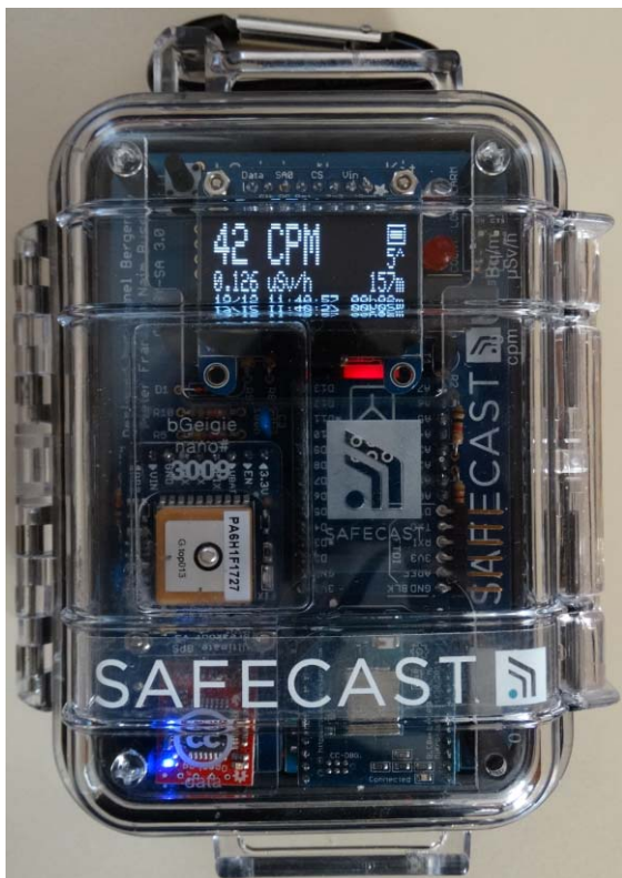
9. ábra. Az összeszerelt, betokozott detektor.
