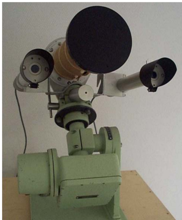
2. ábra. Az Országos Meteorológiai Szolgálat Marczell György Fő-obszervatóriumában működő európai WMO Regionális Napsugárzási Központ HF-19745 abszolút pirheliométere. A két oldalon két kalibrálás alatt lévő Eppley NIP pirheliométer látható.
