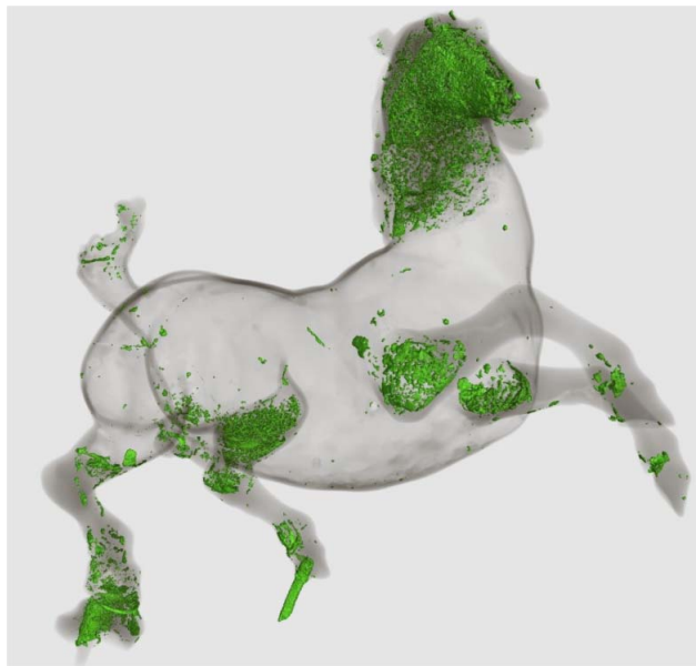
13. ábra. A szobor belsejének neutrontomográfiás leképezése.
