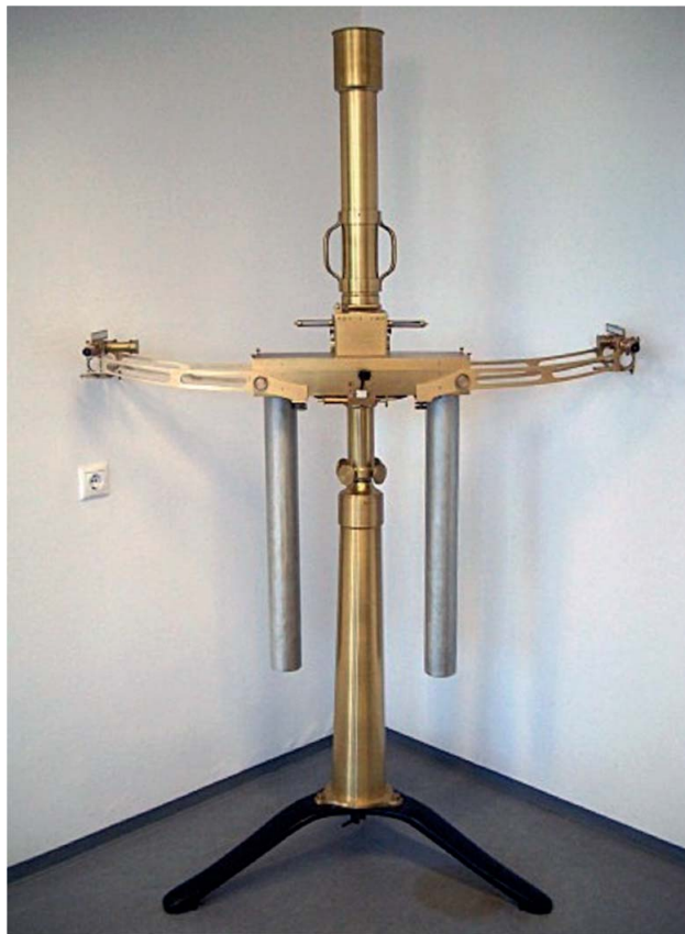
6. ábra. Az Eötvös-féle torziós inga egyik változata, a kettős inga (ennek két kivételéről a Fizikai Szemle 2019/6 és 2019/9 számában írtunk részletesebben – a szerk.).
