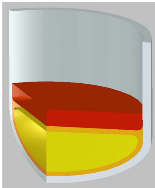
1. ábra. Az olvadék elhelyezkedése a tartályban.
