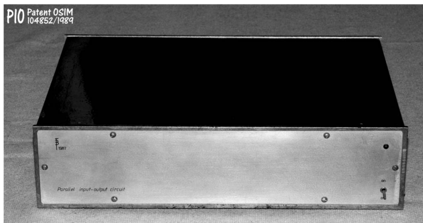
5. ábra. PIO (Parallel Input Output) – Hétportos, kétirányú interfész – 1987.
