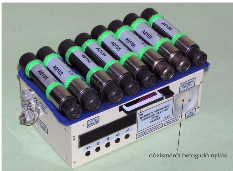
7. ábra. A Pille TLD kiolvasója, tetején dózismérő kulcsok tokban.
