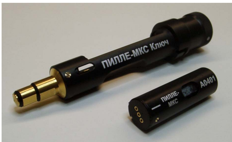
5. ábra. Az új típusú Pille dózismérő és univerzális kiolvasó kulcs.
