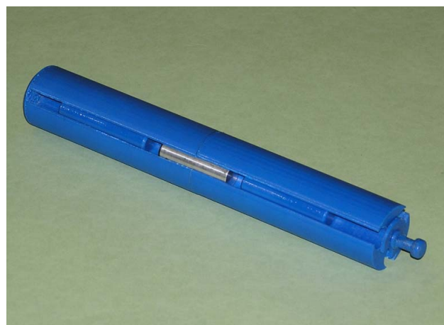
12. ábra. Az új típusú Pille dózismérők fantomba való behelyezésére szolgáló hengeres tartószerkezet prototípusa.
