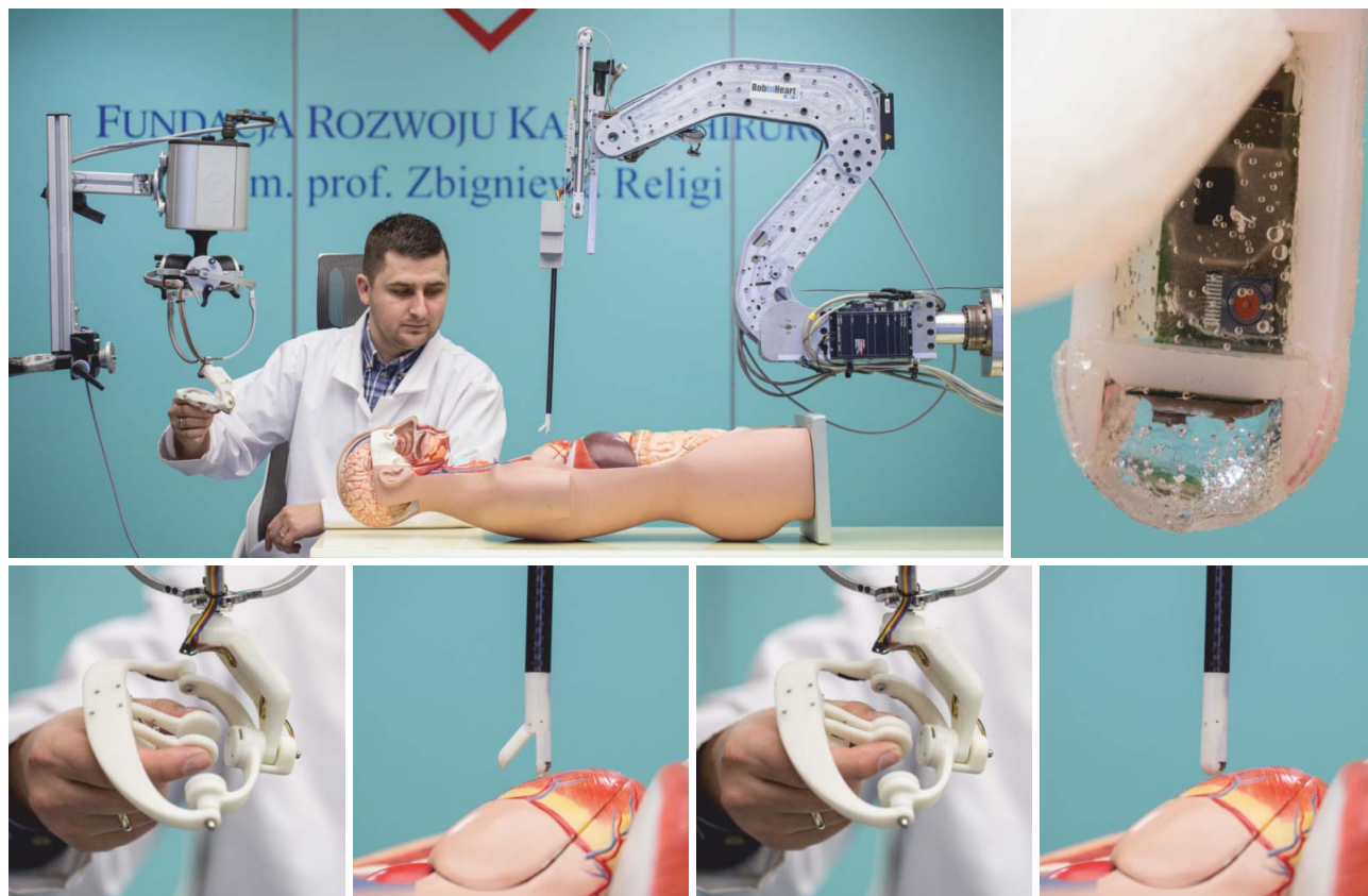
6. ábra. A RobinHeart mc 2 kísérleti sebészrobot és haptikus vezérlése (RobinHand) kiegészítve a kontakt erő mérésre képes „okos” laparoskopppal. A rendszer alkalmas valós idejű erővisszajelzésre a vezérlő sebész számára.
