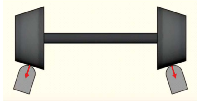
9. ábra. A befelé döntött sínpárra ható erők iránya.
