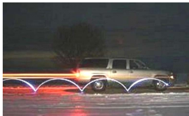
1. ábra. Járműkerék külső pontjának pályája.
