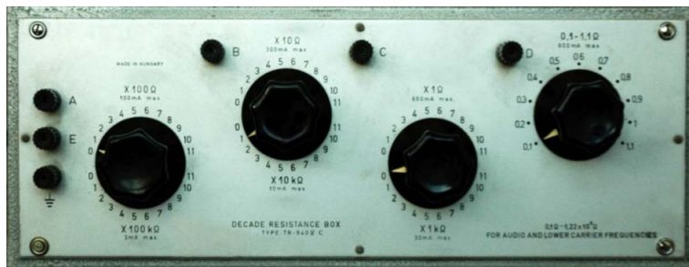
10. ábra. Finoman szabályozható ellenállásdekád 1,2 M \Omega -ig.
