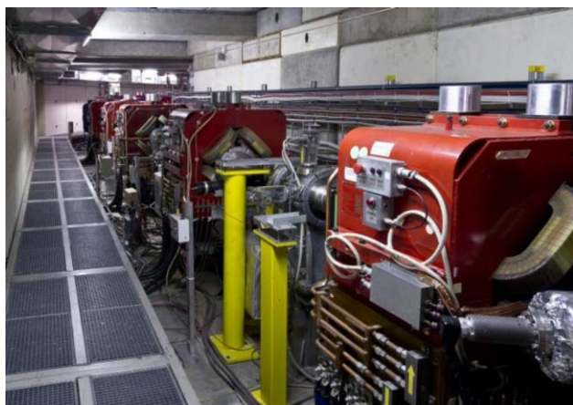
6. ábra. Az Antiproton-lassító tárológyűrűje a mágnesekkel.
