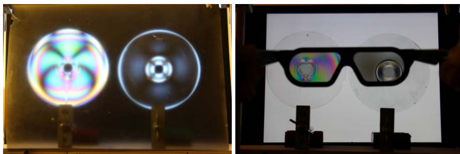
8. ábra. CD-védő korong (bal) és meghántolt CD (jobb) feszültségoptikai vizsgálata keresztezett polárszűrők közt (bal oldali fotó), illetve 3D-s szemüvegen át nézve (jobb oldali fotó).
