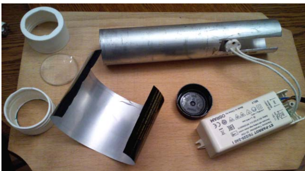
3. ábra. A fényforrás alkotó elemei (fölül) és az összerakott fényforrás (alul).
