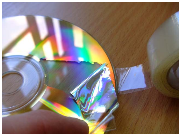
8. kép. A CD hámozása.
