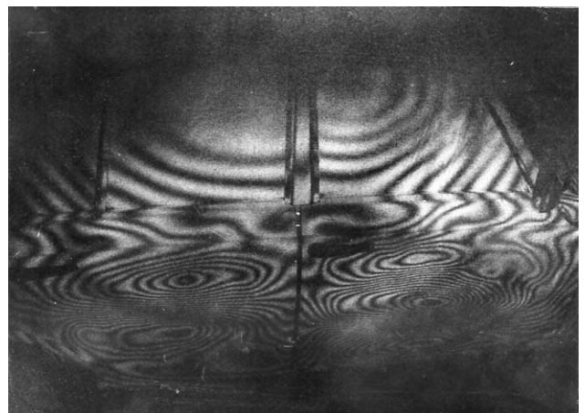
6. ábra. A gépkocsiszekrény két ajtaján kialakuló rezgéseket tükröző interferenciakép.
