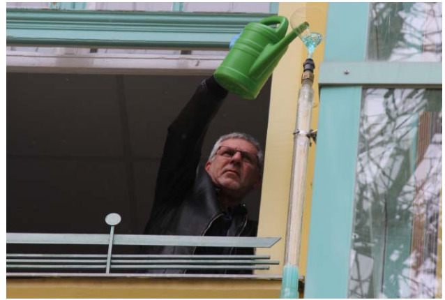
3. kép. A Torricelli-cső feltöltése (fotó: Z. S.).
