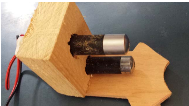
8. ábra. A tartóba szerelt lézerciódák.
