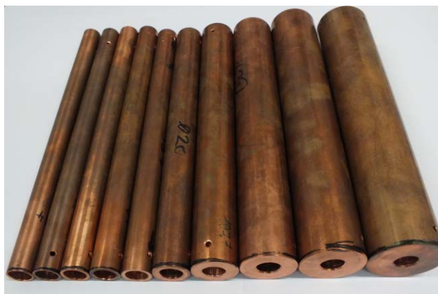
5. ábra. A mérésekhez használt rézcsövek a végek közelébe fúrt lyukakkal.
