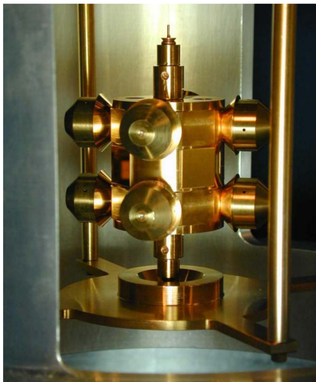
4. ábra. Az Eöt-Wash csoport forgó Eötvös-ingája.
