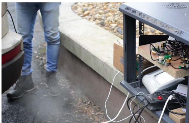
11. ábra. A dízelautó kipufogó gázának mérése.
