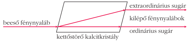
13. ábra. Sematikus rajz a kalcitkristály fénytöréséről.
