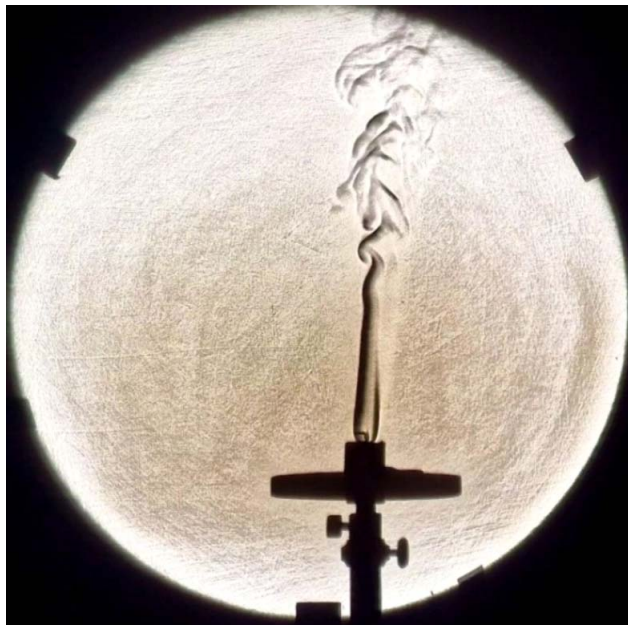
1. ábra. Gyertyaláng hője által keltett áramlás egy általunk készített Schlieren-felvételen.
