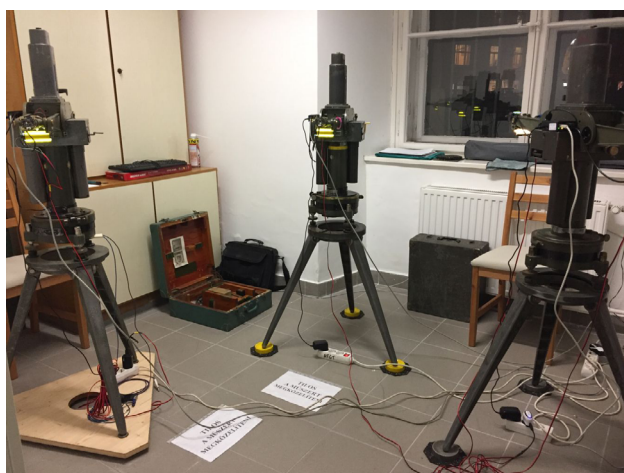
2. ábra. Auterbal-ingák a BME Általános, és Felsőgeodézia Tanszékének gravitációs laboratóriumában
