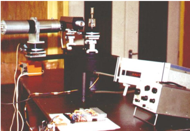
9. ábra. A spektrális mérésekre kifejlesztett korrelációs fényszórás mérő berendezés a 80-as évekből
