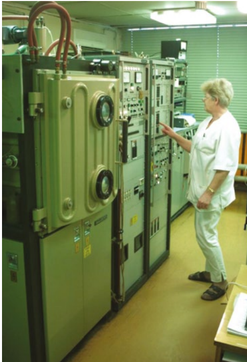
3. ábra. A Balzers párologtató berendezés, amelyen Ferencz Kárpát , Szipőcs Róbert , Kőházy-Kis Ambrus és kollégái kifejlesztették az első csörpölt lézertükröket. A berendezésnél Kaspari János né
