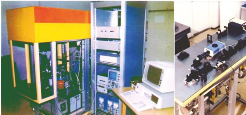
8. ábra. A Lézerionizációs RepülésiIdő-TömegAnalizátor (spektróméter), a LIRITA (balra) és annak optikai rendszere (jobbra)
