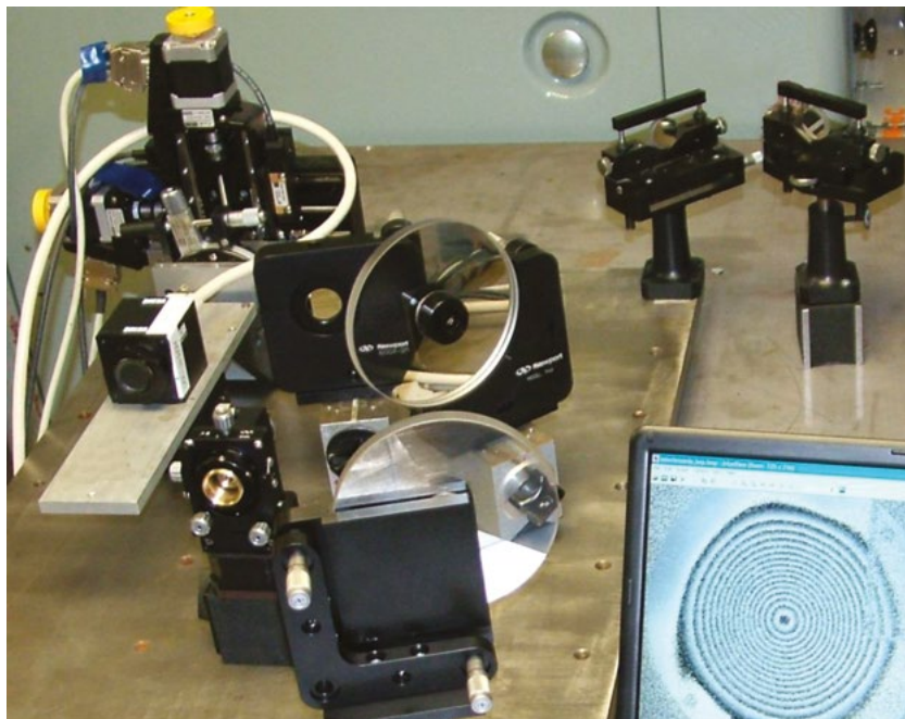
13. ábra. A BME-vel közösen létrehozott DIADEM holografikus berendezés laboratóriumi változatának részegységei
