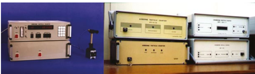
10. ábra. Az első hazai mikroprocesszoros pormérő berendezés a 80-as évekből (balra) és a környezetvédelmi mérésekre kifejlesztett lézeres berendezések prototípusai (jobbra)
