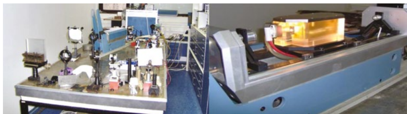
2. ábra. A szilárdtestlézer-laboratórium a 80-as években, benne az első (ma is működő) hazai 120 W-os, folyamatos üzemű szilárdtestlézerral (balra) és a szilárdtestlézer rezonátorral (jobbra). Ennek minden részegysége (a mechanika, az optika és az elektronika) a KFKI-ban készült
