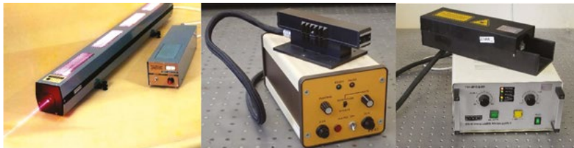
1. ábra. Az első hazai 633 nm-es He-Ne lézer (balra), hordozható foszfátüveg minilézer (középen) és szemészeti műtétekhez használt hazai impulzusüzemű hordozható szilárdtestlézer (jobbra). A He-Ne lézerek a MOM-nak lettek átadva sorozatgyártásra, a szilárdtestlézereket később a Technoorg Kft. gyártotta
