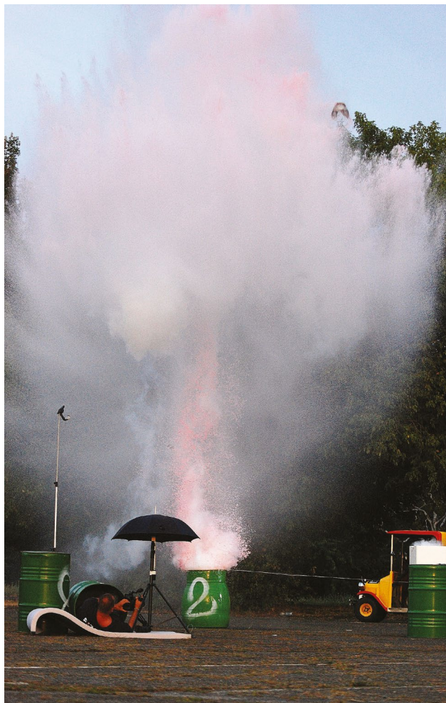
9. ábra. Hordó alakítása lökeshullámmal
