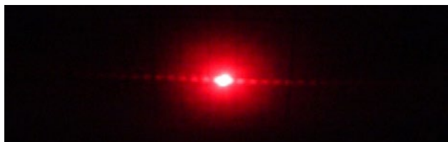
3. ábra. A hajszállal létrehozott diffrakciós kép (saját készítésű kép)
