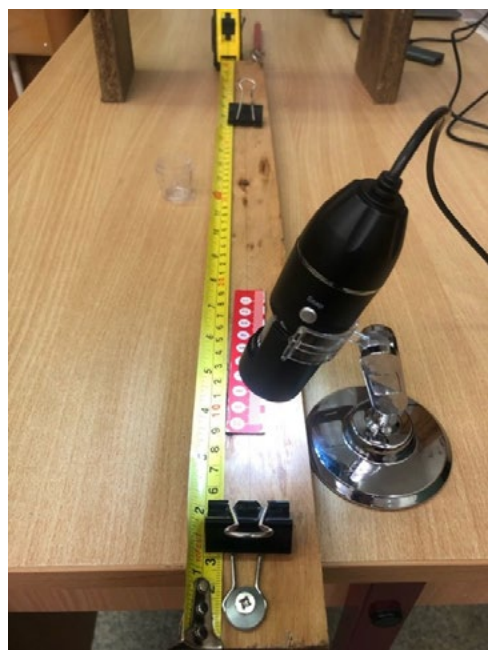
7. ábra. A hajszálak nyújtásának vizsgálatához készített „nyújtópad”, ami képes a hajszálak keresztmetszetének csökkenését is detektálni az előtérben látható mikroszkóp segítségével
