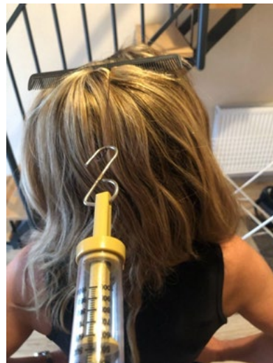
6. ábra. A fésülködés közben fellépő erőhatások mérése
