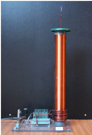
8. ábra. Tesla-transzformátor működés közben. A 2019-es debreceni ankét eszközkiállítására készítette Pál Zoltán ( https://www.fizkapu.hu/fizfoto/fotok/fizf1033.jpg )
