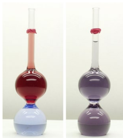
6. ábra. A Vida-féle varázslombik. Az eszközzel a víz és az alkohol keveredésekor létrejövő térfogatcsökkenés mutatható be. Ez a jelenség azt igazolja, hogy a folyadék részecskéi között van szabad hely ( https://www.fizkapu.hu/fizfoto/fotok/fizf0076.jpg )
