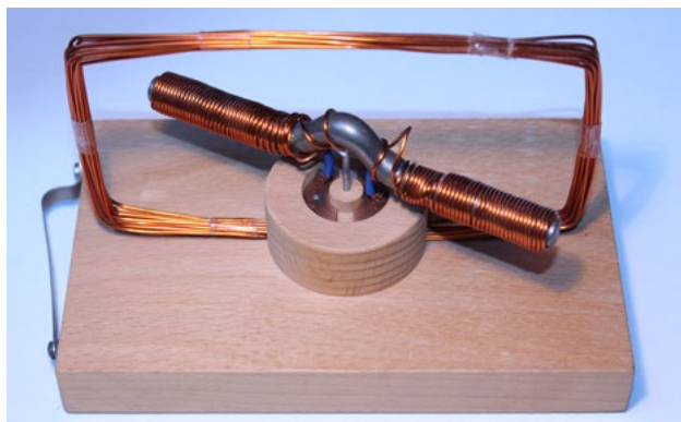
7. ábra. A Jedlik-motor higany nélküli, működőképes rekonstrukciója. Tervezte Jarosievitz Zoltán ( https://www.fizkapu.hu/fizfoto/fotok/fizf1073.jpg )
