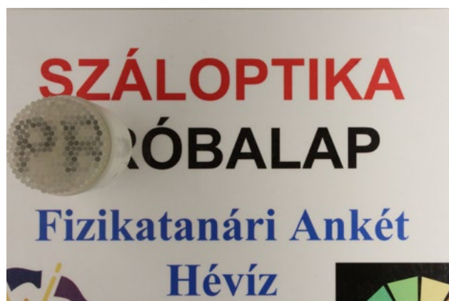
2. ábra. A száloptika működő modellje. A 2015-ös hévízi ankéton bemutatott, 2 mm átmérőjű plexi szálakból összeállított eszköz ( https://www.fizkapu.hu/fizfoto/fotok/fizf0839.jpg )
