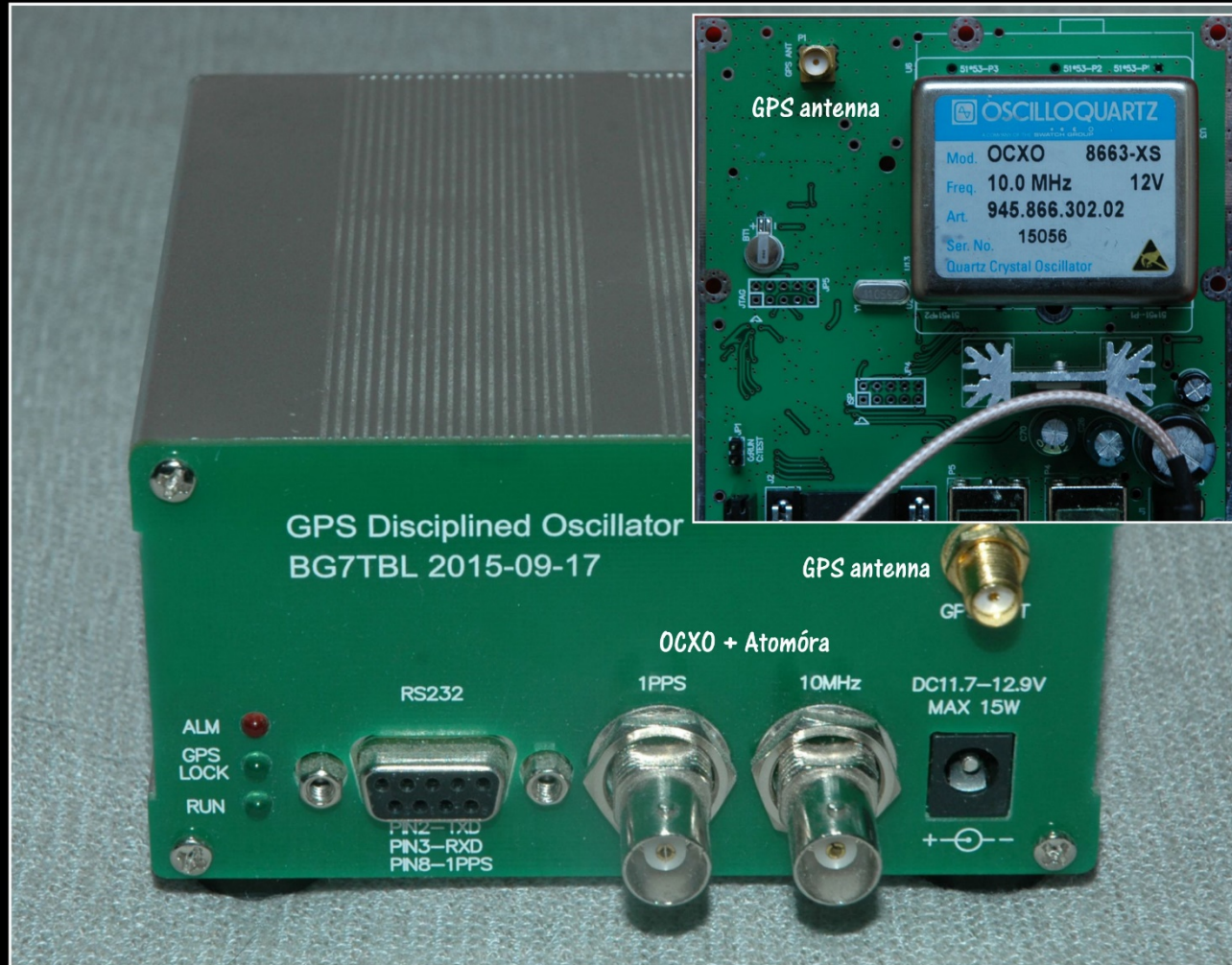
GPS-vezérelt időközetalon. Az Atomórával létrejött kapcsolat után az 1PPS TTL etalonjel periódusa T = 1,000000000 \text{ s} \pm 20 \text{ ps}
